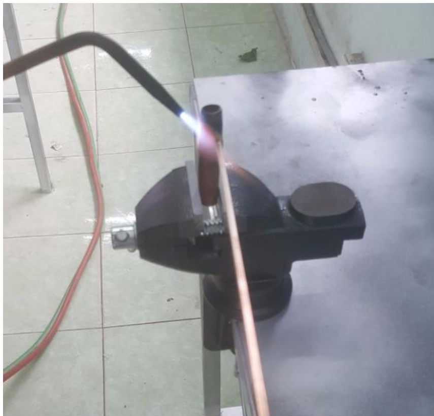
Hình 33: Hàn nối hai ống có đường kính bằng nhau
