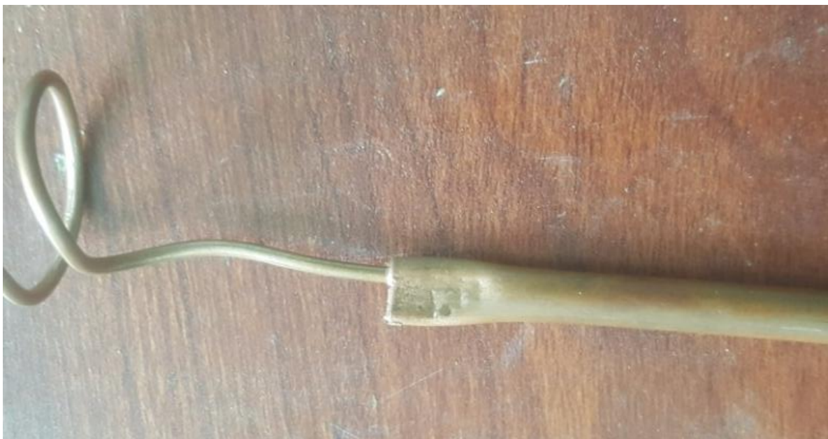
Hình 37: Chuẩn bị hàn nối ống với ống mao
