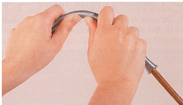
Hình 5. Uốn ống bằng lò xo
