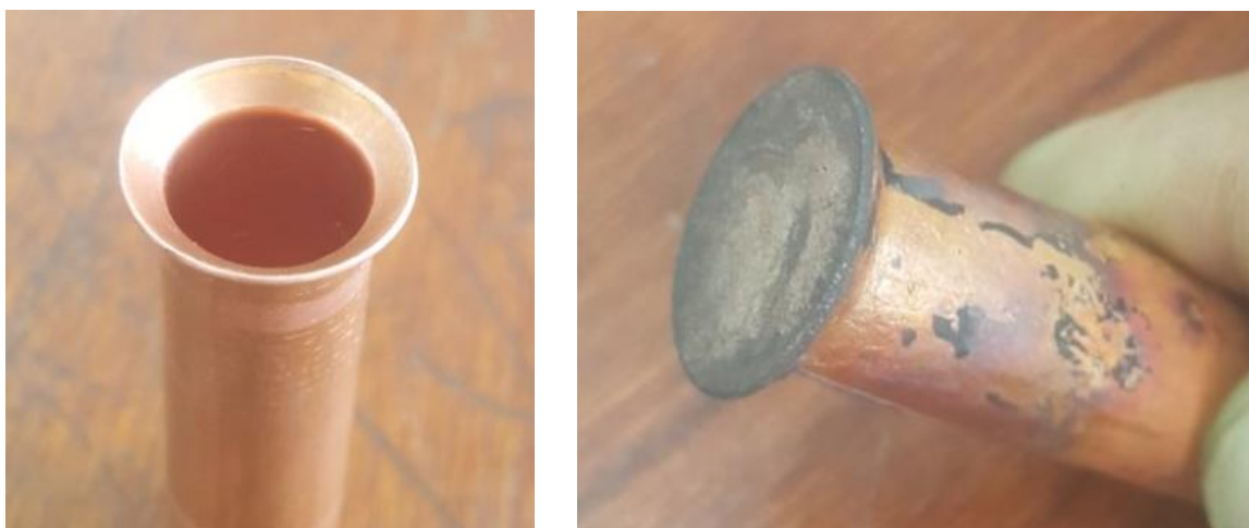
Hình 39. Kỹ thuật hàn Pinch off – loe sản phẩm và hoàn thành sản phẩm
