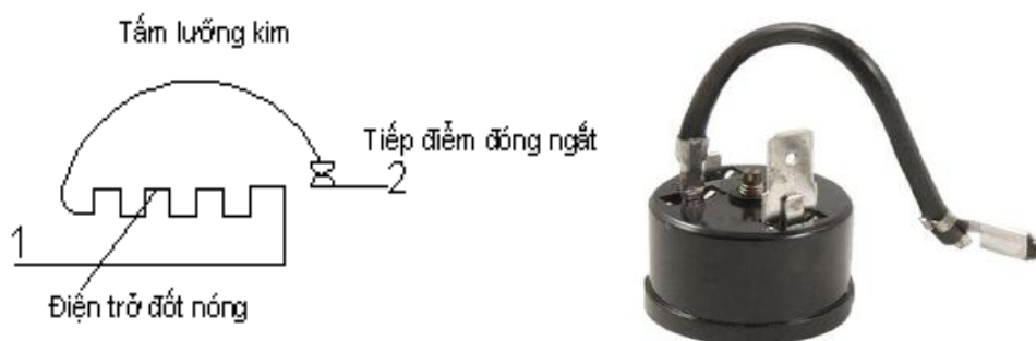
Hình 53: Cấu tạo thermit
