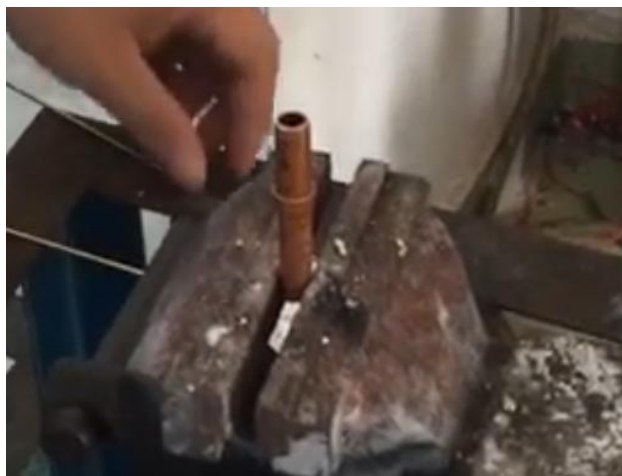
Hình 32: Chuẩn bị hàn nối hai ống có đường kính bằng nhau
