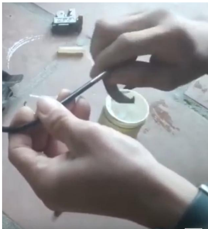
Hình 41. Dùng giấy nhám làm sạch bề mặt vật liệu hàn (sắt)
