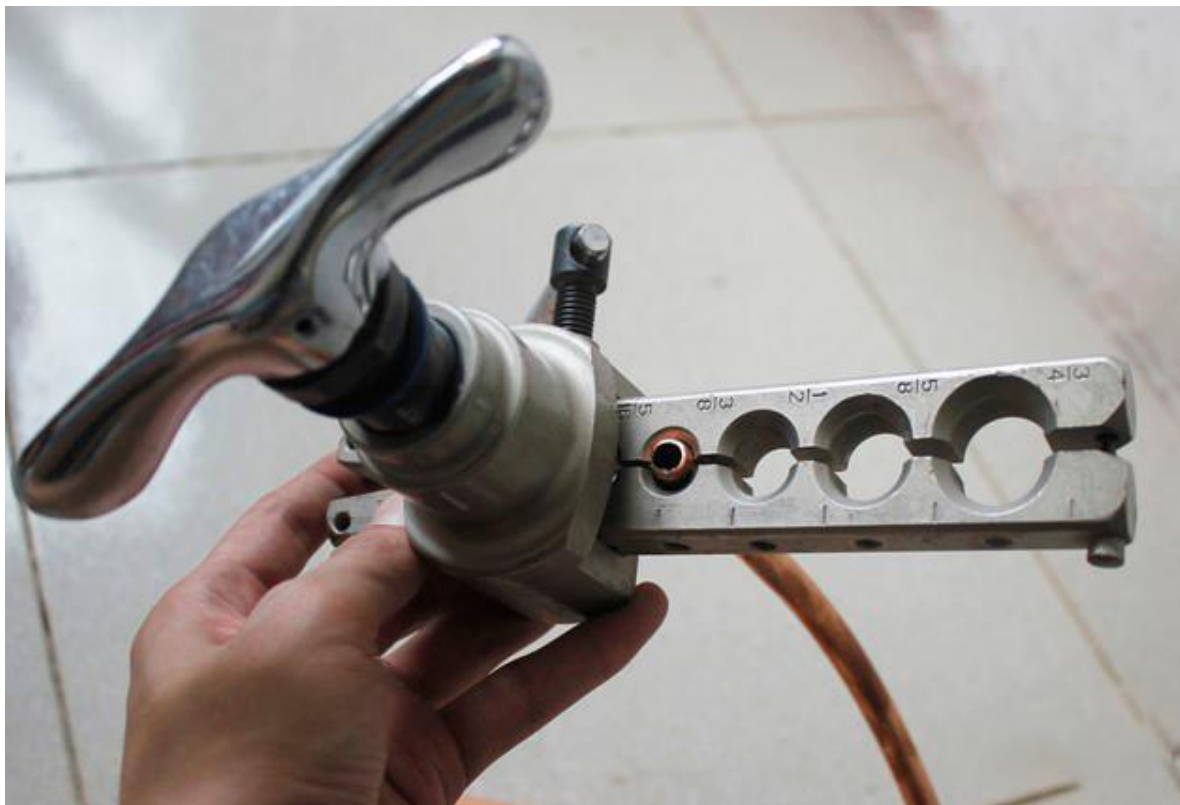
Hình 11: Đặt đầu côn vào giá kẹp
