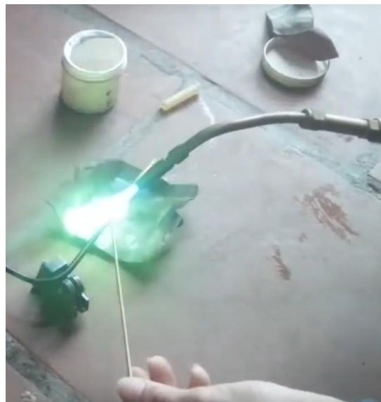
Hình 44. Chấm que hàn vào đầu ghép
