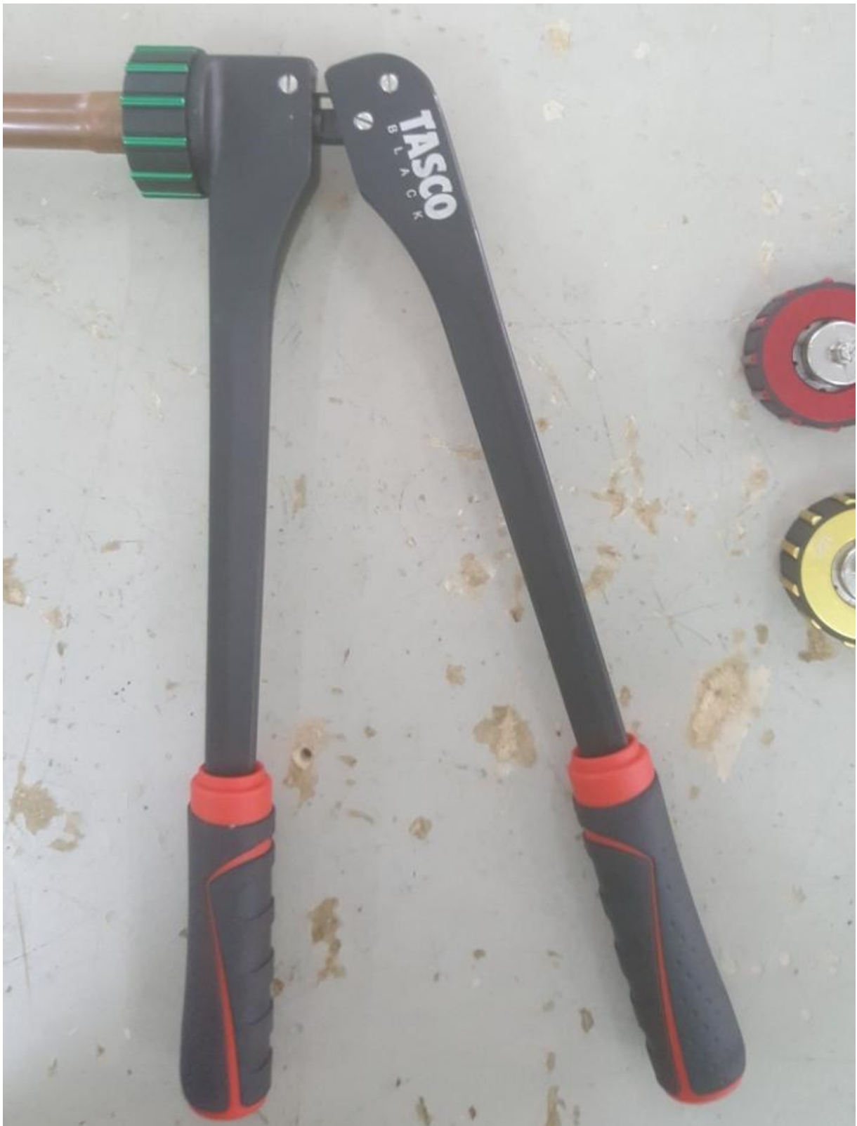
Hình 20: Đặt ống vào và tiến hành nong ống
