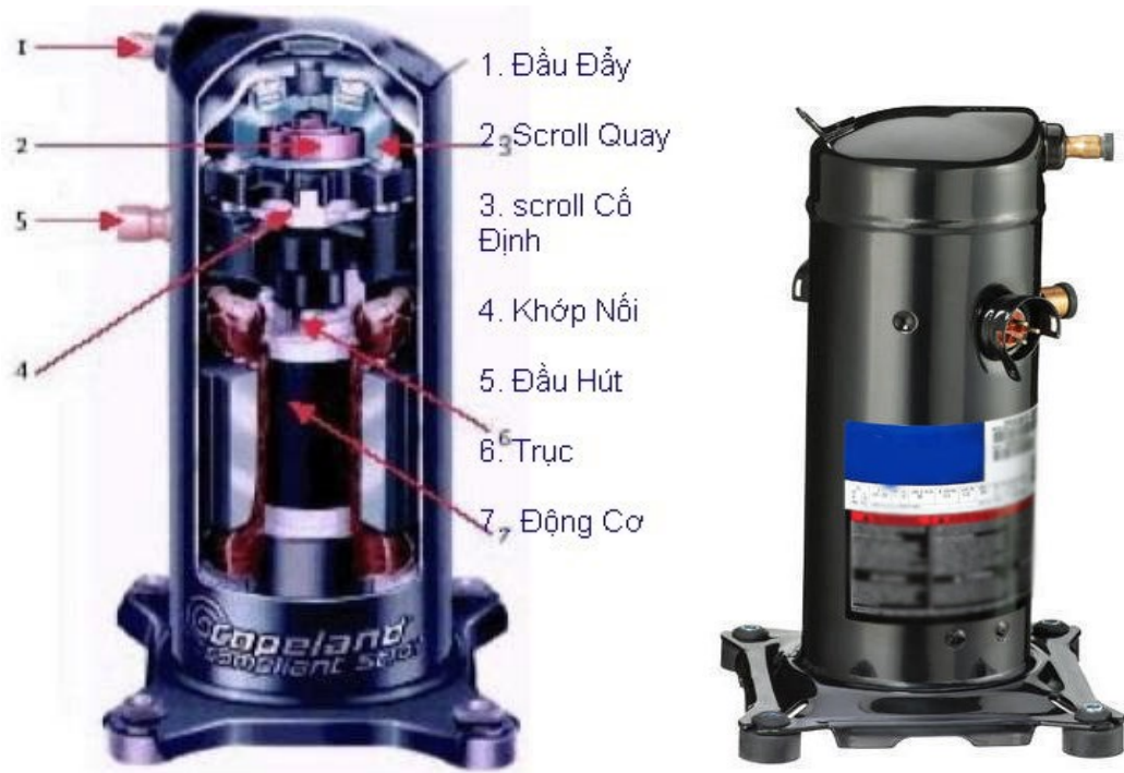
Hình 2.15 : Cấu tạo máy nén xoắn ốc Copelan
